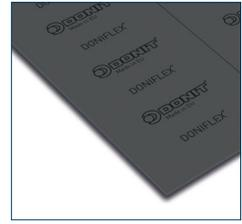
DONIFLEX® G-MD es un avanzado material compuesto a base de grafito y aramida fabricado en condiciones libres de disolventes orgánicos. DONIFLEX® G-MD combina las ventajas del producto químico y la resistencia térmica del grafito con la fuerza de la aramida. Este material de "densidad media" buena resistencia al estrés para juntas de ancho estrecho. Es particularmente adecuado para vapor y caliente así como para calderas o radiadores.
